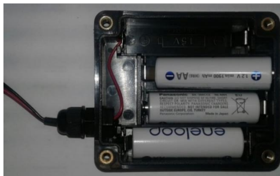
Abb. 17 – Batterietausch
