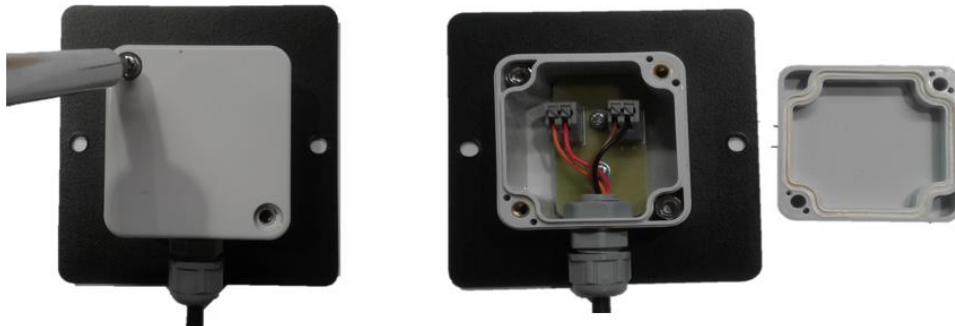
Abb. 9 - Öffnen der Rückseite des Wandschalters
